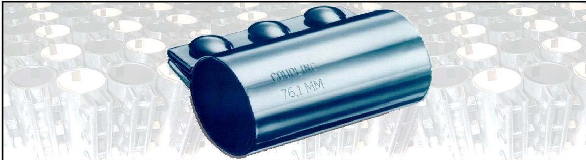
Druckflex-Kupplungen, die einzigartigen preiswerten Kupplungen zur Verbindung oder Reparatur von Röhren und Rohrnetzen. Lieferbar in fast allen Größen von 1" bis 20", in Millimetergrößen (Rohr-Außendurchmesser 25,4 mm – 508,0 mm) oder in anderen Zwischenmaßen. Baulängen von 101,6 mm (mit 2 Klemmschrauben) bis 304,8 mm (mit 6 Klemmschrauben) größere Baulängen auf Anfrage.
